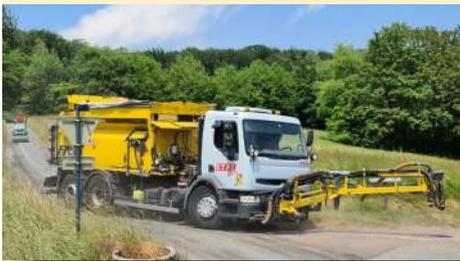
Vous l'avez vu passer dans les rues de Chagey : le blow-patcher est un enrobeur projeteur qui permet de réparer les dégâts de chaussée type nid de poule, faïençage, défoncement des bords de chaussée.
